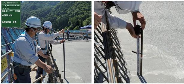
写真-6 N式貫入試験実施状況
