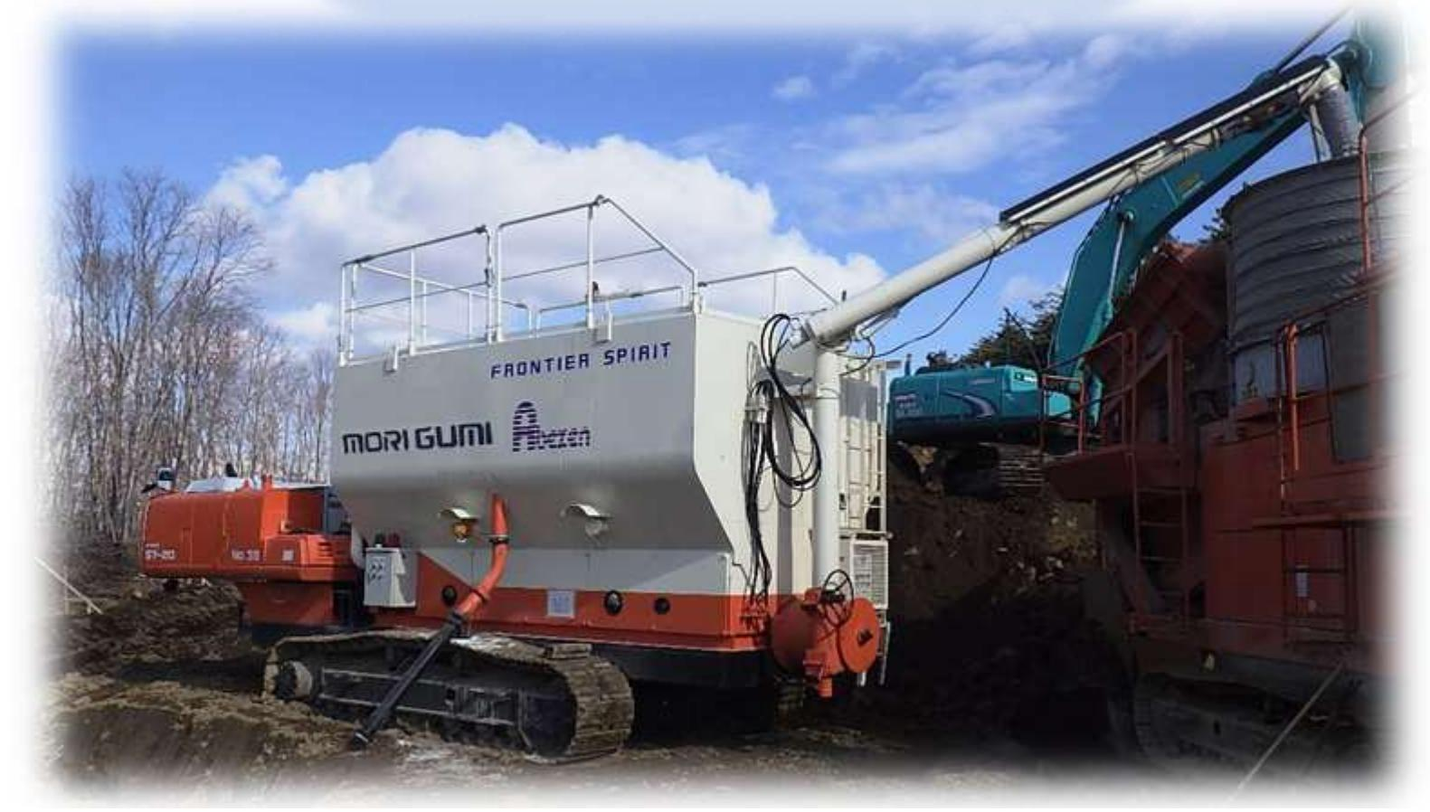
概要説明：自走式土質改良工は原料土を現地改良する場合に用いられ、プラントが建設できない狭隘地や長距離移動が必要な条件でも現地施工が可能である。その際、固化材として使用するフレコンはタイヤ式運搬車で搬入されるが、自走式土質改良機までの搬入走路が走行できない場合には、その区間について不整地運搬車による積替え運搬を行う必要がある。土質改良時には、土質改良機付属クレーンでフレコンを貯留装置上まで吊上げて、袋底を開き改良材を落下投入する。
