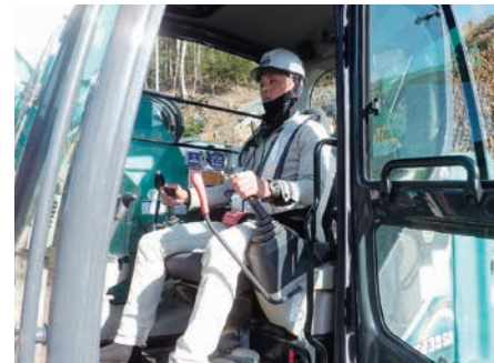
バックホウのシートベルトにマーカー装着
