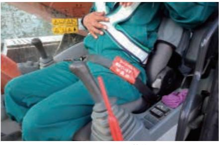
バックホウのシートベルトにマーカー着装
